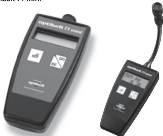
Plage de mesure Range di misurazione: 10-600 Hz
